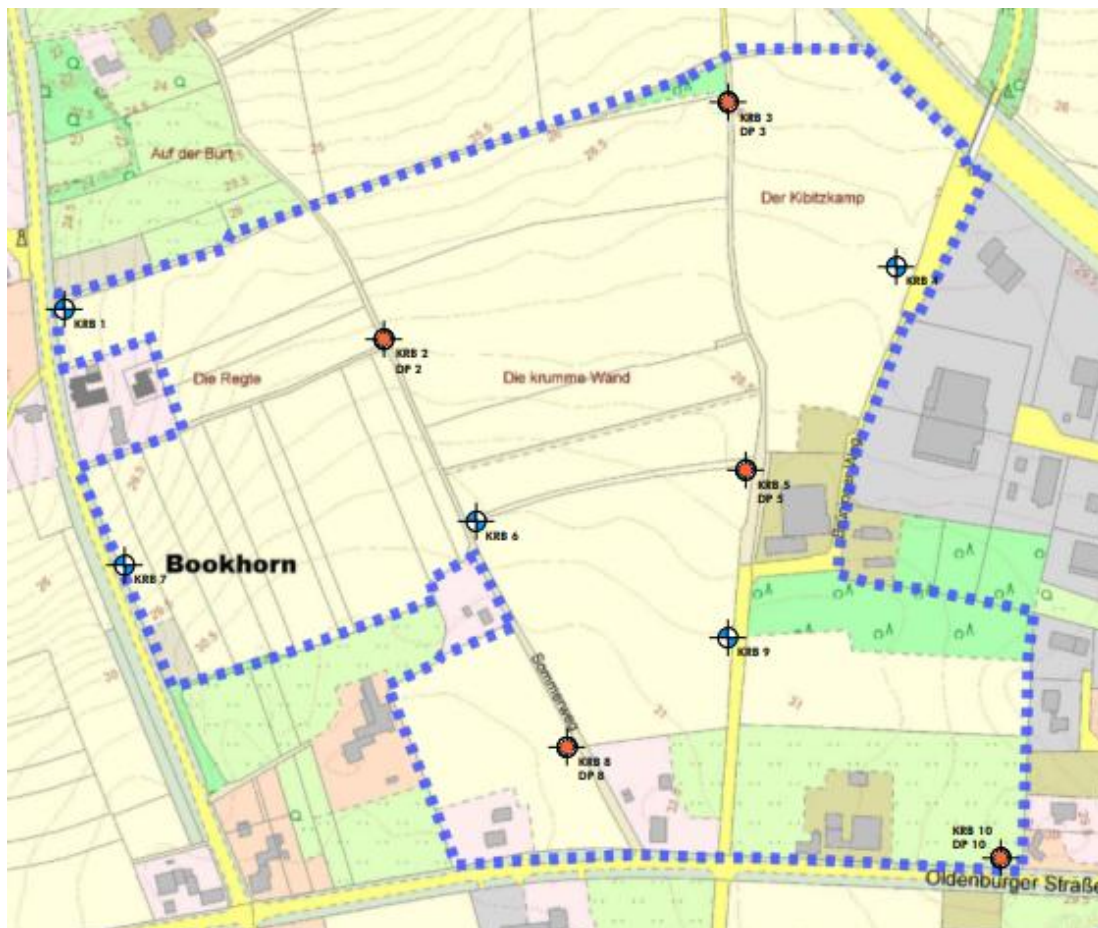
Abbildung 10: Auszug Bohrpunkteplan (Baugrunduntersuchung November 2016)
