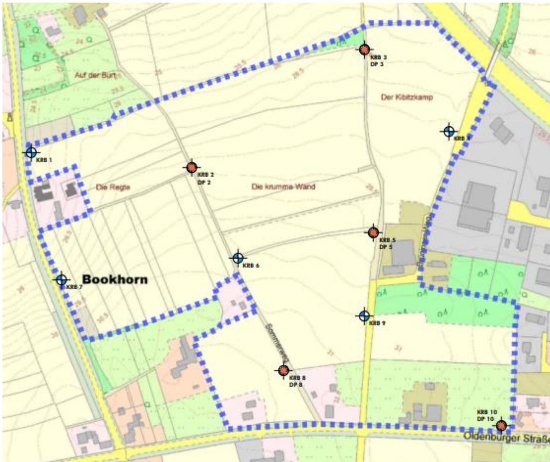
Abbildung 11: Auszug Bohrpunkteplan (Baugrunduntersuchung November 2016)
