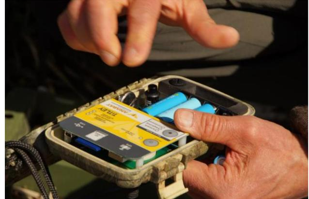
Abbildung 4: Wechsel der Batterien
